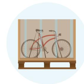
Asegurar el paller y colocar cuñas a la bicicleta a fin de que no se mueva durante el transporte, forrar con stretch film y acrtón para evitar rayaduras u otras imperfecciones, es bueno que, con suncho le den un soporte para que no pueda moverse y está segura.
